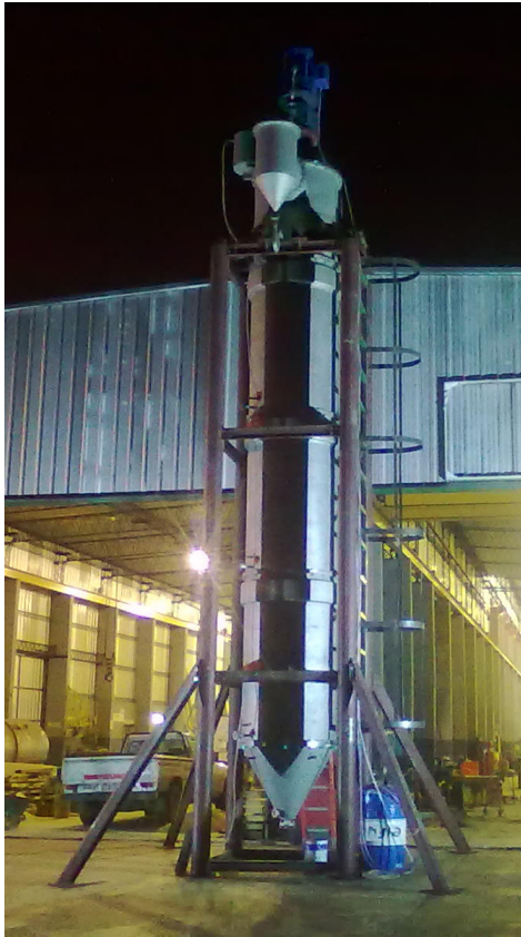
Figura 1 : SECADOR DE LECITINA DE PELÍCULA FINA-AGITADA DE 20 m 2
